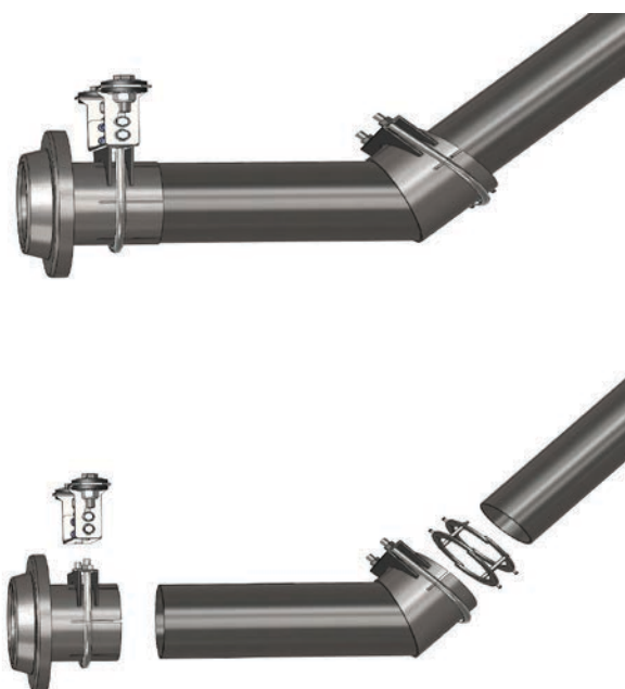
Bild: exempel på modifiering avgasrör
