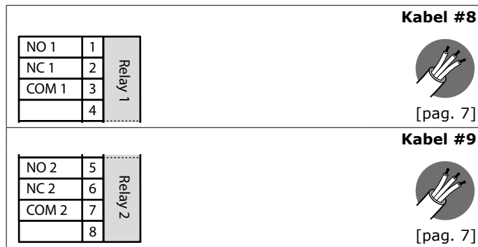
Fig. 4.23 Aansluiting van de relaisuitgangen
