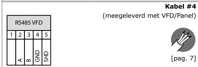
Fig. 4.11 Aansluiting van Plymovent VFD/Panel
