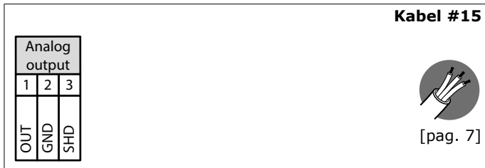
Fig. 4.13 Aansluiting op de interne ventilatordruksensor
