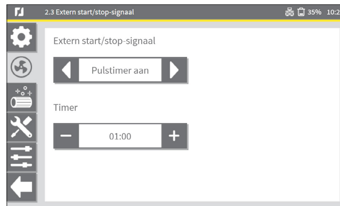
Fig. 4.14 Extern start/stop signaal: Pulstimer aan
