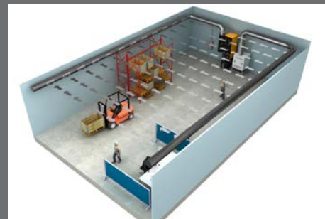
U-vormig push-pull systeem met 1 filterunit en 1 ventilator
