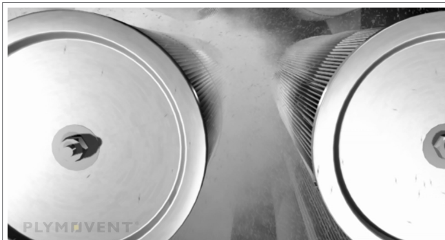
De effectieve RamAir™ pulse amplifier (pulsversterker): de twee filterpatronen worden individueel gereinigd door middel van persluchtstoten
