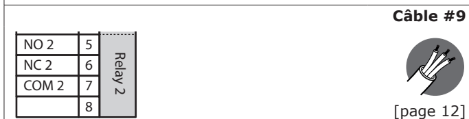
Fig. 4.29 Raccordement des sorties de relais
