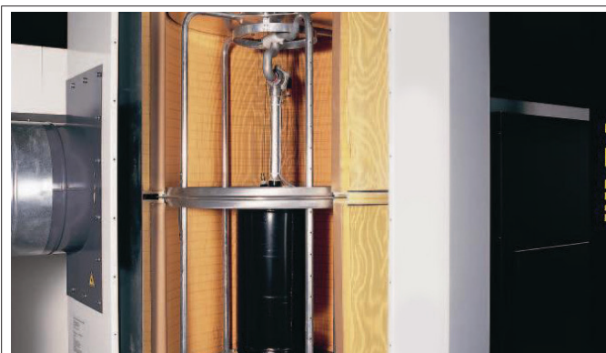
Sistema RoboCleanPlus para la limpieza automática por secciones mediante pulsos de aire comprimido
