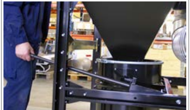
Depósito de polvo (80 litros) manejable sobre un carro (opción), incl. varilla de elevación y manivelas
