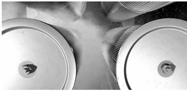
El amplificador de impulsos efectivo RamAir™: limpieza individual de los cartuchos de filtro por pulsos de aire comprimido
