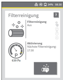
Abb. 4.6 Statusanzeige für Filterreinigung
