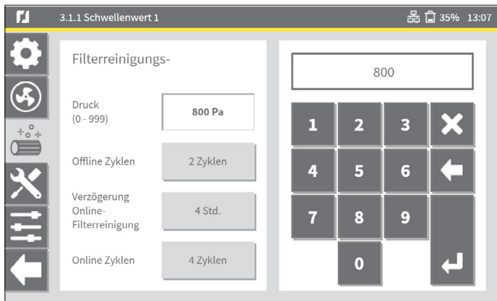
Abb. 4.9 Einstellung der Schwellenwerte
